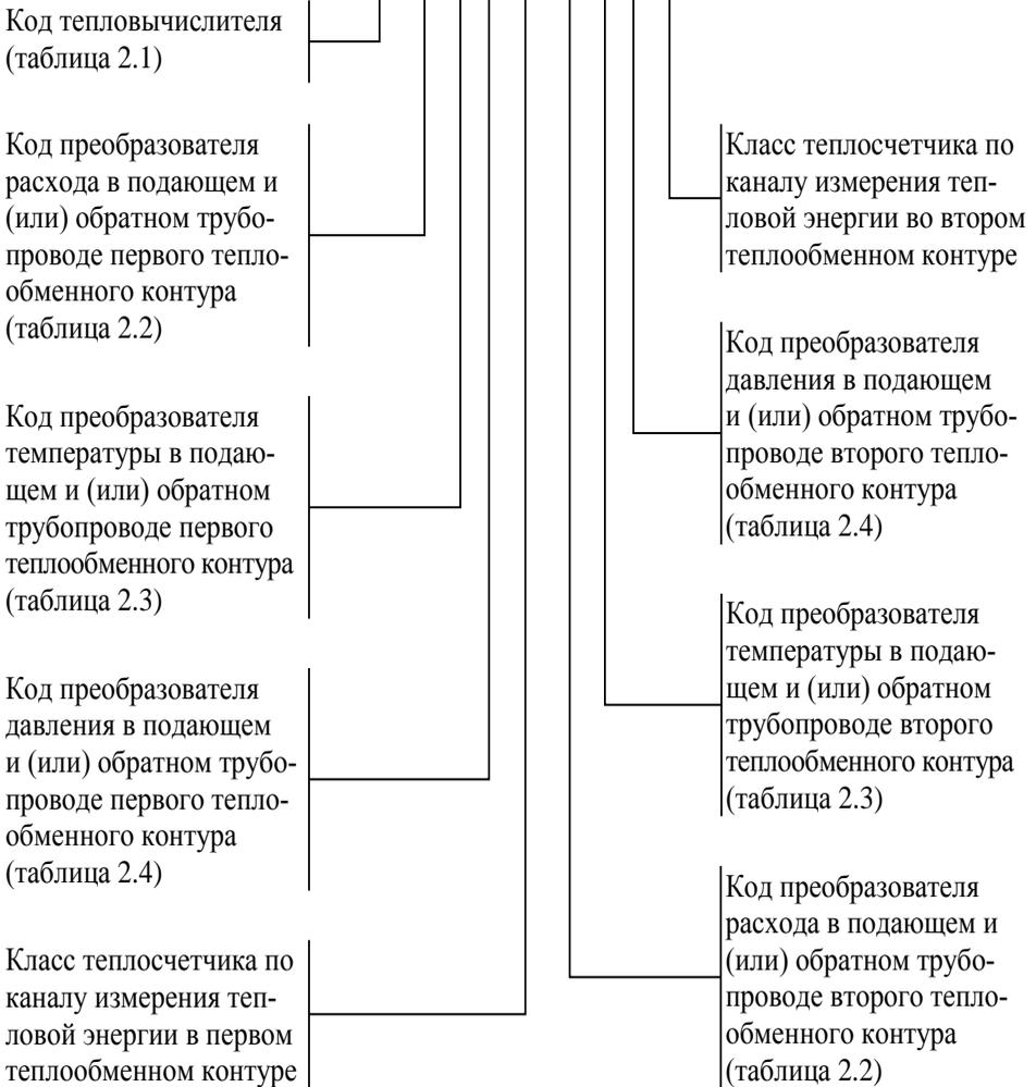
Рисунок 2.1 – Структура обозначения исполнений теплосчетчиков
