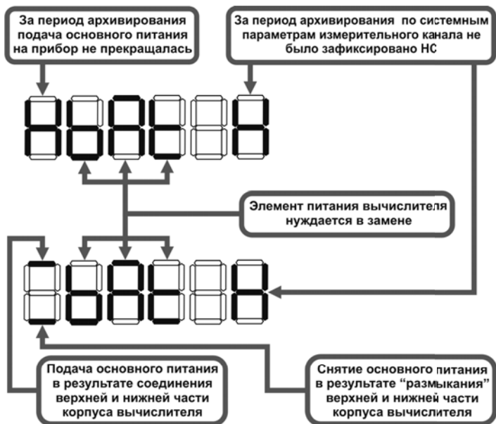
Рисунок 3.7 – Коды НС, возникающих по техническим параметрам
